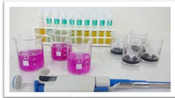
Δείγματα COD, NO 2 -N και απορρόφησης χρώματος
