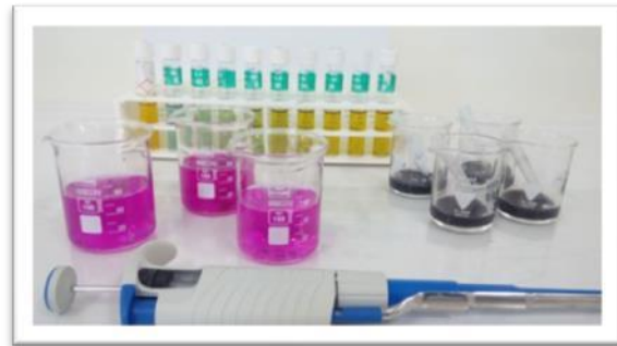
Δείγματα COD, NO 2 -N και απορρόφησης χρώματος
