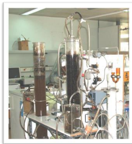
Ερευνητική μονάδα Αναερόβιας Χώνευσης
