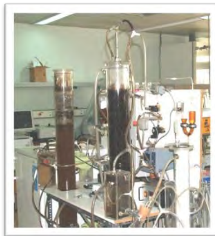
Ερευνητική μονάδα Αναερόβιας Χώνευσης
