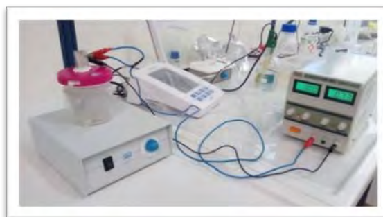
Ηλεκτροκροκίδωση πόσιμου νερού
